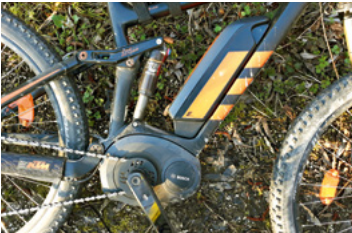
Abbildung 2.5: Fahrrad mit Mittelmotor und Lithium-Akku extern am Holm
