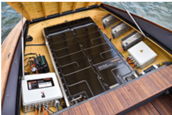
Abbildung 2.8: Li-Akku vom BMW i3 in einem Boot der Firma Frauscher (BMW Group)
