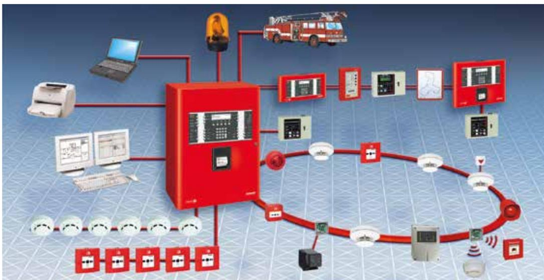
Abbildung 2.1: Brandmeldeanlage: Sterntechnik (links), Ringtechnik (rechts) (Schrack Seconet AG)
