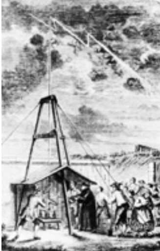
Abb. 4: T. F. Dalibard, 1752. Untersuchungen zur Identität von Gewitter- und Reibungselektrizität Erster Nachweis der Gewitterelektrizität durch Dalibards Blitzableitungsexperiment am 10. Mai 1752. Aus Les grandes inventions anciennes et modernes dans les sciences, l'industrie et les arts , 1870
