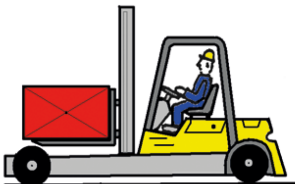
Last innerhalb der Radbasis und Deichselstapler = führerscheinfrei
